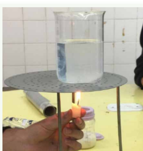
Figura 2 - Correntes de convecção do leite (líquido branco) dentro de uma porção de água devido ao aquecimento. Fonte: Relatório 3 - Estudantes do CEMEB: Felipe, Jaine, Cauã, Pedro, Júlia e Víctor.
