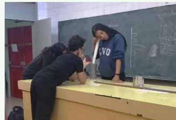
**Figura 8** - Análise da ressonância do som. Um estudante segurava o celular emitindo onda sonora e outro, com ouvido numa das pontas do cano PVC, alterava a altura dentro da água para reconhecer a ressonância.
