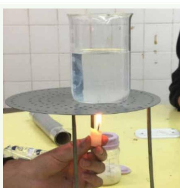
Figura 2 - Correntes de convecção do leite (líquido branco) dentro de uma porção de água devido ao aquecimento.
