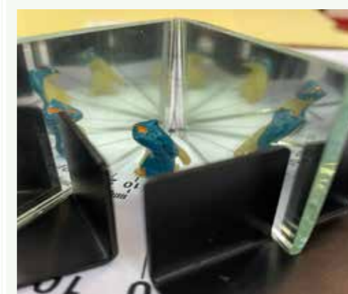
Figura 10 - Formação de imagem com a combinação de dois espelhos planos. Fonte: autores.
