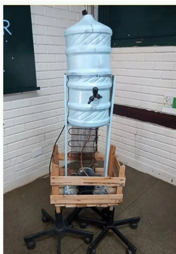
Figura 12 – Protótipo do módulo Refrizer, antes da substituição das rodas e reforço da estrutura de sustentação. Fonte: acervo pessoal.
