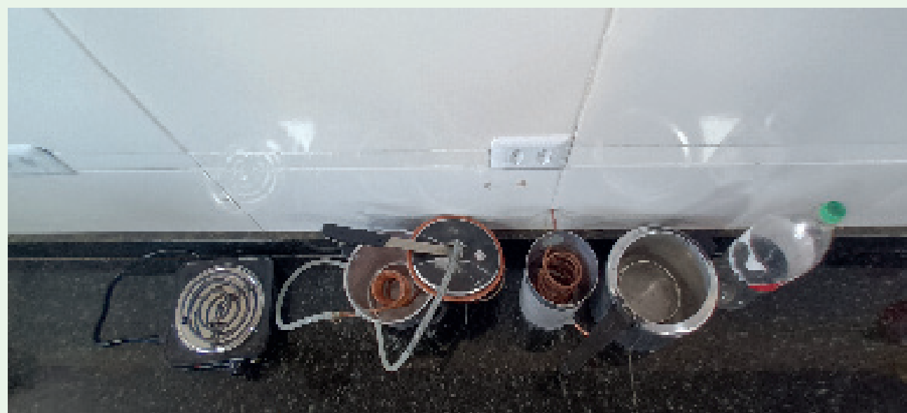
Figura 1 – Materiais de baixo custo utilizados no processo de destilação por arraste a vapor
