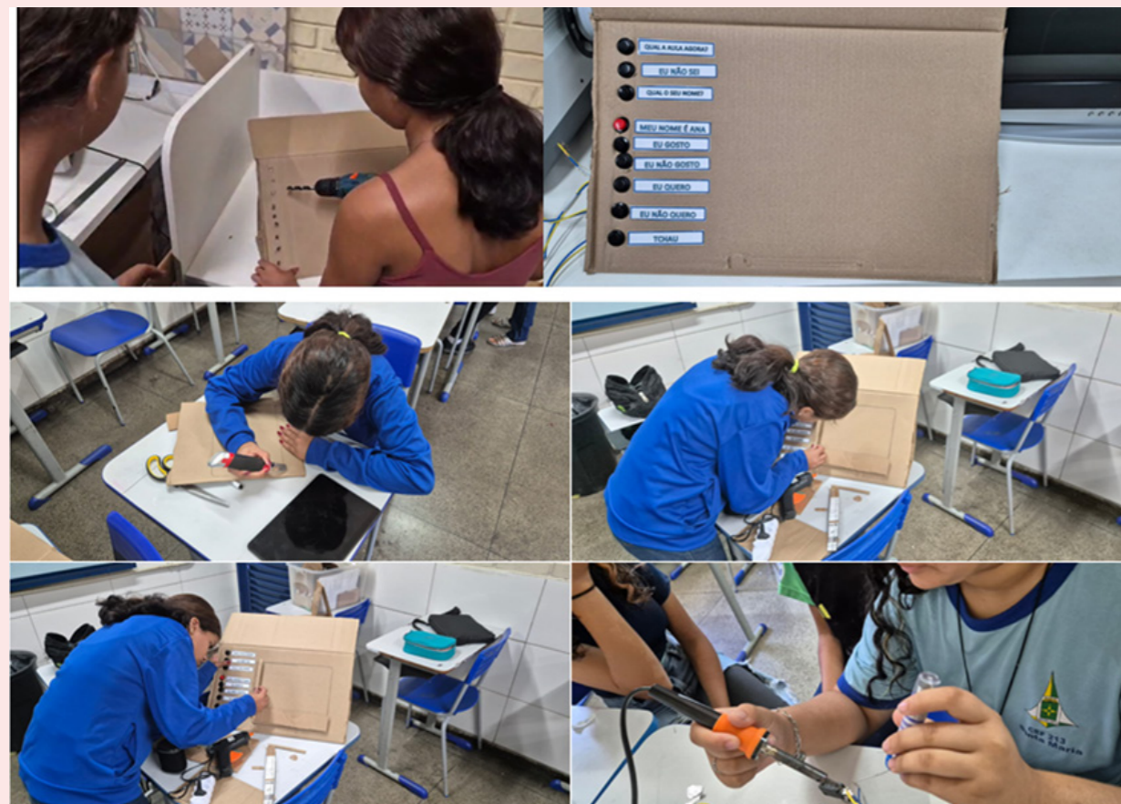
Figura 5 – Processo de construção do primeiro protótipo da caixa robótica. Processo de soldagem dos fios nos botões, recorte e colagem do papelão. Instalação dos botões na caixa robótica.
