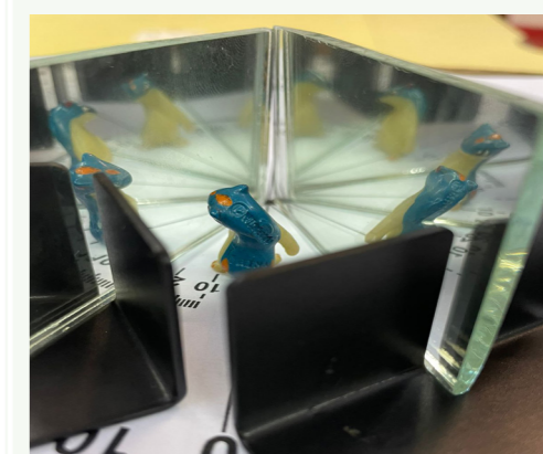
Figura 10 - Formação de imagem com a combinação de dois espelhos planos. Fonte: autores.
