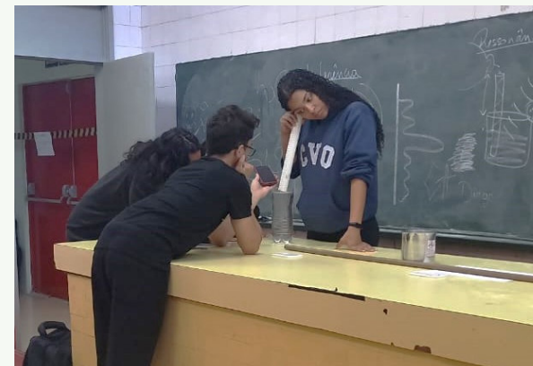
Figura 8 - Análise da ressonância do som. Um estudante segurava o celular emitindo onda sonora e outro, com ouvido numa das pontas do cano PVC, alterava a altura dentro da água para reconhecer a ressonância. Fonte: autores.
