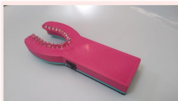
Figura 3 - Protótipo 2 impresso, com visão interna e montado com botão I/O na lateral. Fonte: autores.
