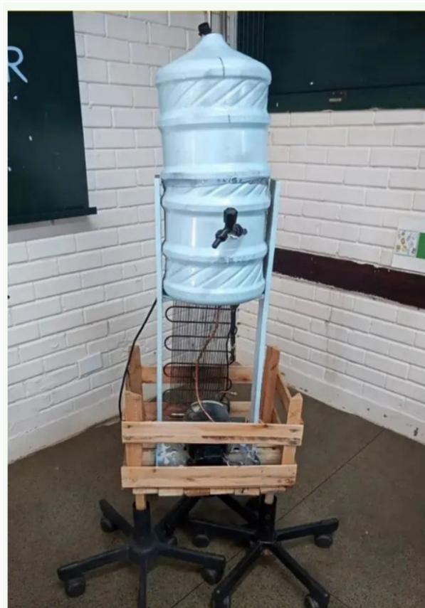
Figura 12 – Protótipo do módulo Refrizzer, antes da substituição das rodas e reforço da estrutura de sustentação.
