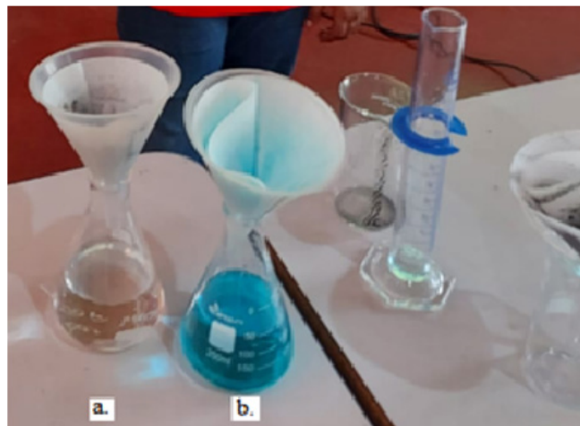
Figura 3 – Processo de filtração com e sem a utilização de carvão ativado: a) Filtração com adição de carvão ativado. b) Filtração sem adição de carvão ativado
