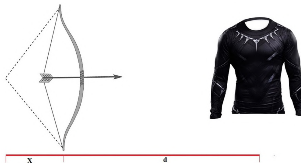
Figura 10: A linha tracejada indica a tração máxima da corda. As linhas vermelhas delimitam as grandezas escalares das distâncias “ x ” e “ d ”.
